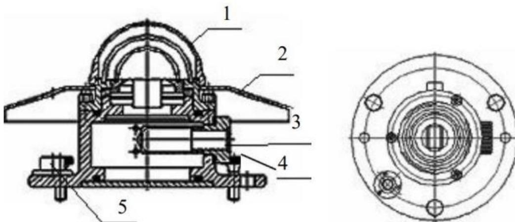
Рисунок 2 – Структурная схема радиационного пиранометра ТВQ
