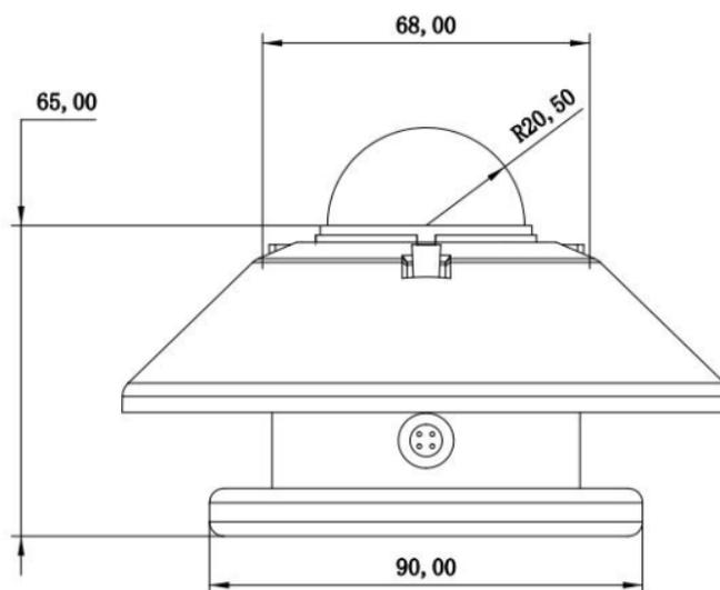
Рисунок 3 Габаритные размеры
