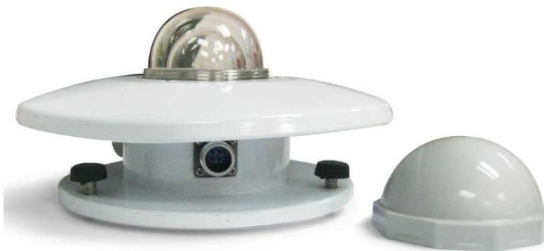
Рисунок 1 – Внешний вид радиационного пиранометра ТВQ
